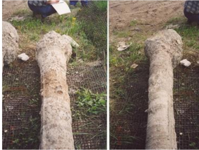
Рисунок 1 Извлеченные сваи с камуфлетным уширением [3]
