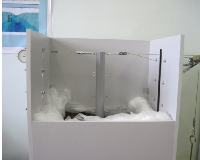
Рисунок 3 – Стенд с испытываемой сваей
