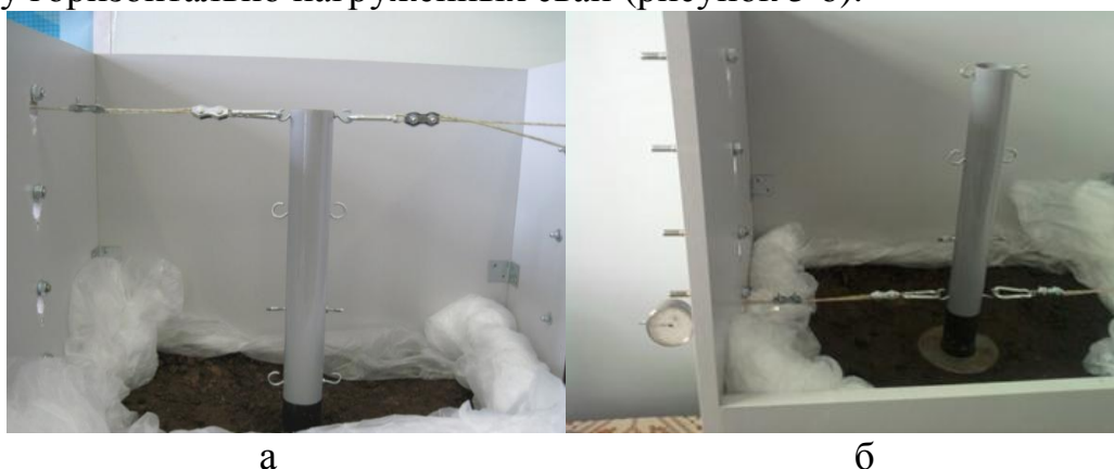
Рисунок 5 – Проведение испытаний а) фрагмент приложения нагрузки на уровне верха опоры; б) фрагмент испытания с уширением диаметром 2 d
