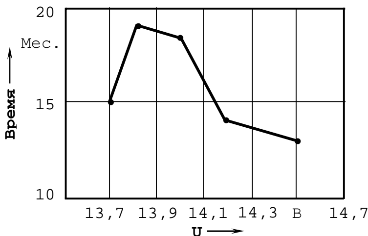
Рисунок 1 - Зависимость срока службы батарей 6СТ-60 от уровня регулируемого напряжения генераторной установки на автомобиле ГАЗ-24
