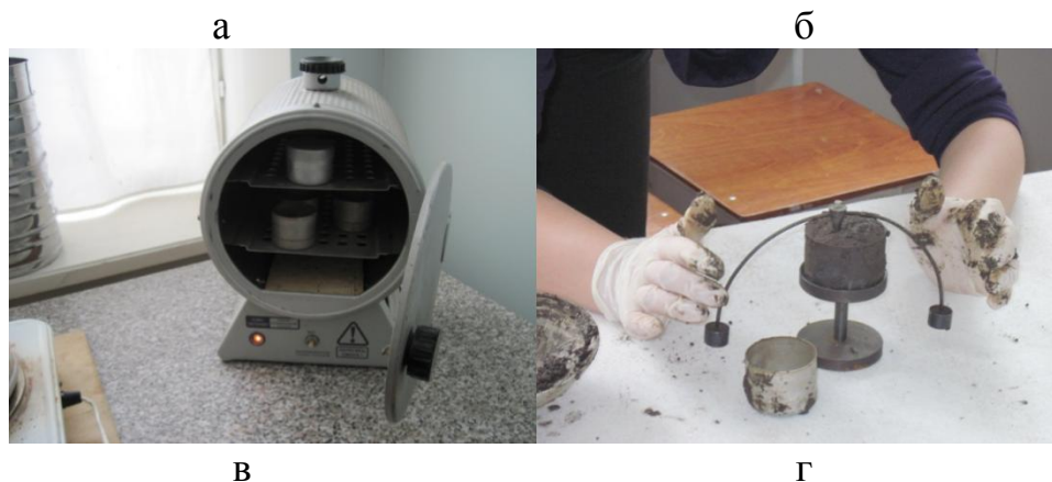
Рисунок 4–Лабораторные исследования грунта а) определение плотности грунта методом парафинирования; б) взвешивание грунта на электронных весах; в) определение характерных влажностей; г) определение предела текучести опытного грунта
