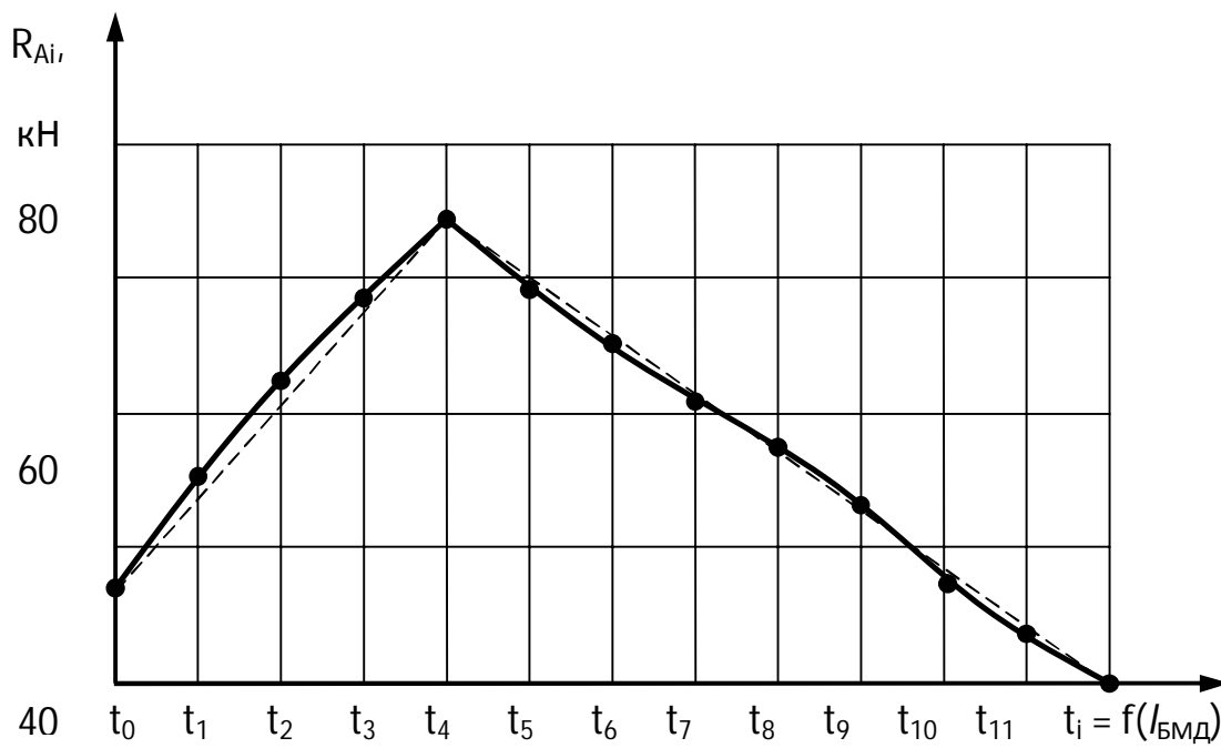
Рисунок 5 – Изменение нагрузки на опору А в плоскости XOY.
