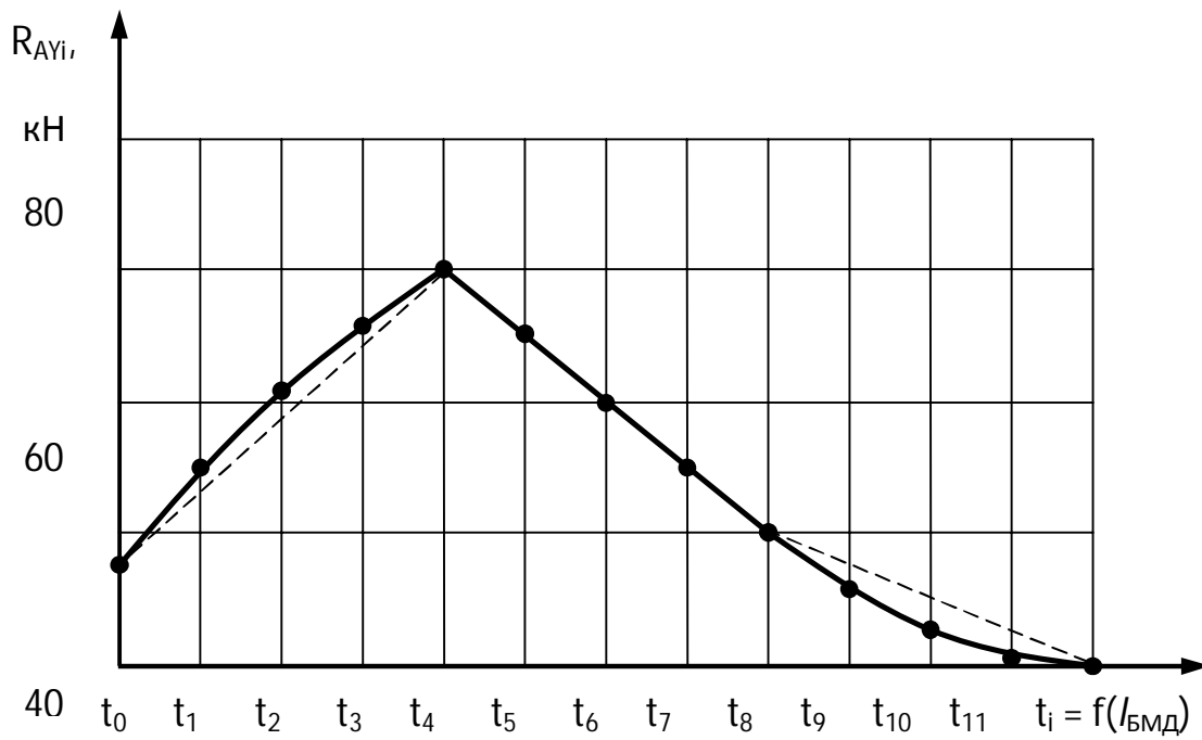
Рисунок 4 – Изменение нагрузки на опору А в направлении оси OY.
