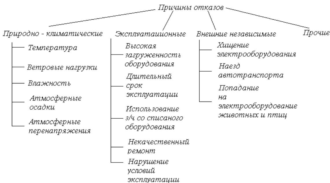
Рисунок 1 – Основные причины отказов электрооборудования напряжением 0,38...10 кВ
