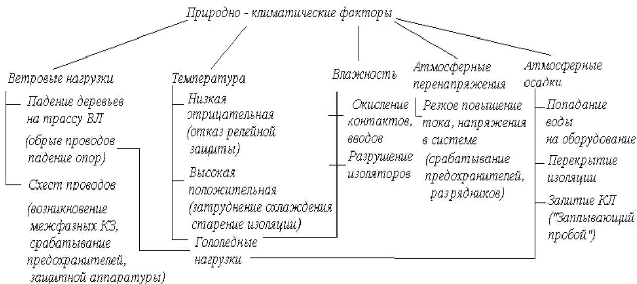
Рисунок 4 - Схема влияния природно-климатических факторов на отказы электрооборудования напряжением 0,38...10 кВ.
