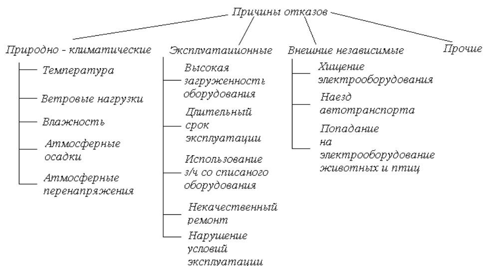
Рисунок 1 - Основные причины отказов электрооборудования напряжением 0,38...10 кВ
