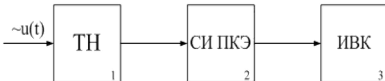
Рисунок 2 - Модули многофункционального прибора организации мониторинга
