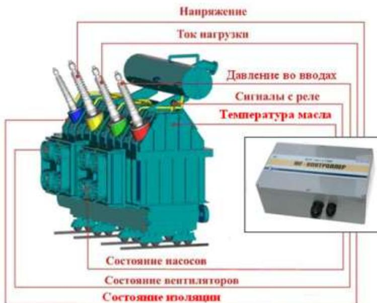
Рисунок 1 - Регистрируемые параметры трансформатора при его мониторинге
