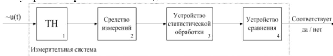
Рисунок 1 - Организация измерительной системы: 1 — нормирующий преобразователь напряжения — ТН; 2 — средство измерений; 3 — устройство статистической обработки результатов измерений; 4 — устройство сравнения.
